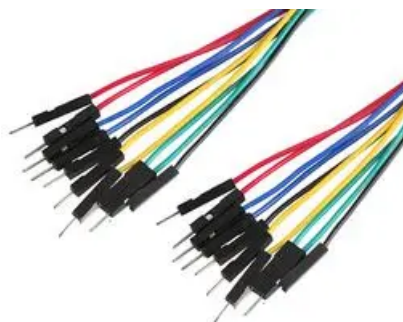
Figura 4.5: exemplo de jumper cable do tipo macho. Fonte: PLATT (2016).
