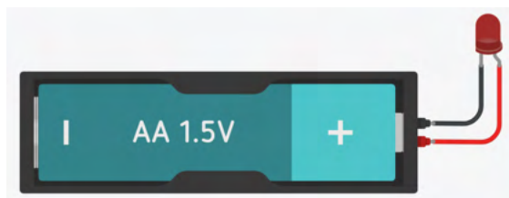
Figura 5.1: exemplo do circuito com uma pilha de 1.5V e um LED vermelho.
