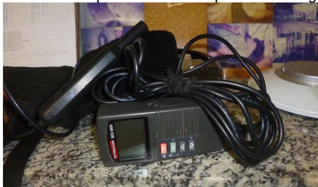
Figura 10 - Aparelho usado para medir a temperatura da água e o oxigênio.
