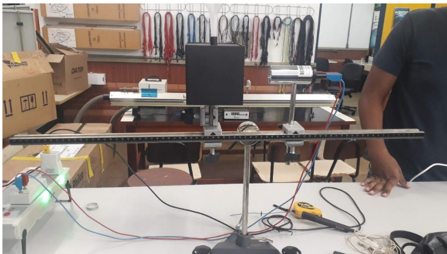
Imagem 12: arranjo experimental do cubo de Leslie. Fonte: Acervo dos autores.
