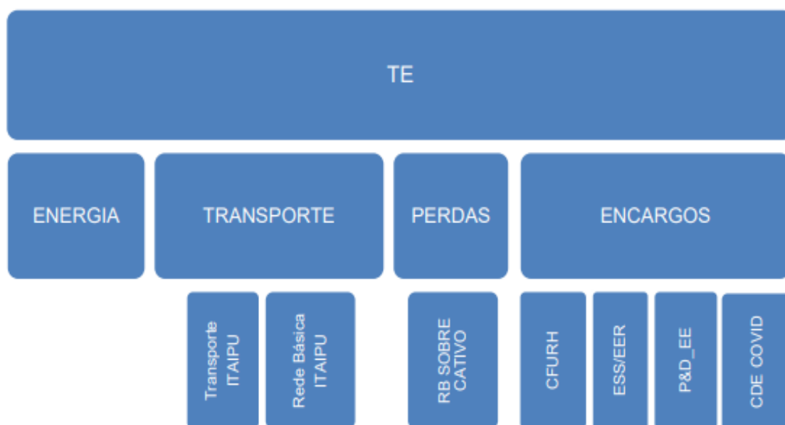
Figura 7 - Elementos que compõem a Tarifa de Energia
