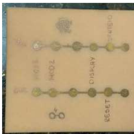
Figura 73 – Foto da placa de fenolite virgem após passar pela solução
