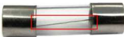
Figura 13 – Indicação do filamento de um fusível exemplo
