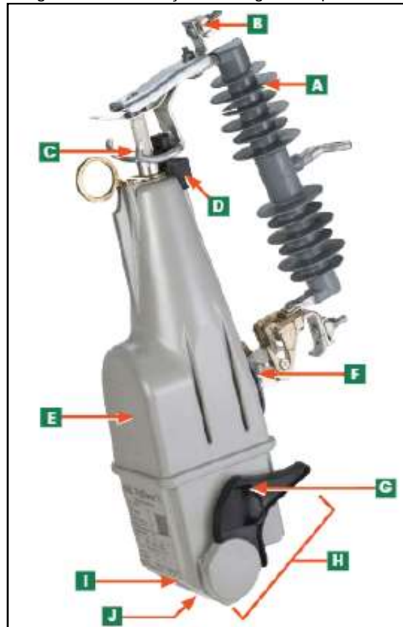
Figura 15 – Construção do Religador TripSaver II
