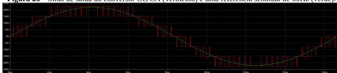
Figura 26 – Sinal de saída do conversor CC/CA (vermelho) e uma referência senoidal de 60Hz (verde).
