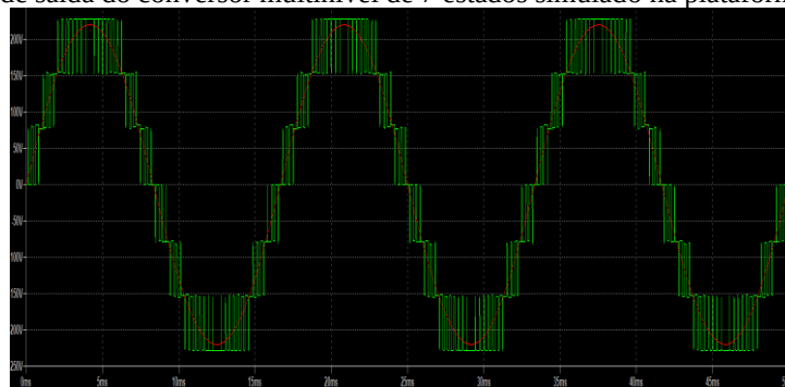
Figura 27 – Sinal de saída do conversor multinível de 7 estados simulado na plataforma LTspice.
