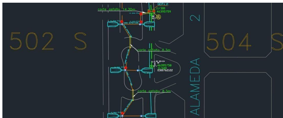
Figura 17 - Detalhe Iluminação Pública da AV. NS-02 (Entre LO-11 e LO-13).
