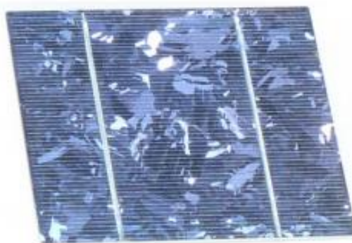
Figura 6 - Célula de silício policristalino
