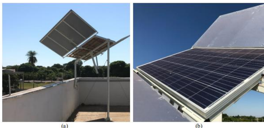
Figura 21 - Suporte metálico, módulo e espelhos planos. (a) vista geral e (b) vista frontal
