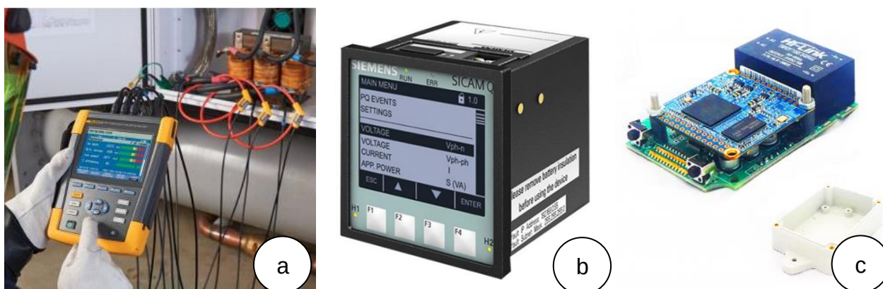
Figura 4 - Exemplos de equipamentos de monitoramento e análise de qualidade de energia elétrica
