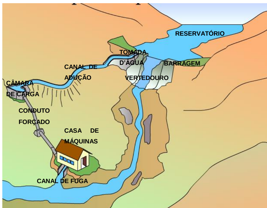
Figura 1: Principais componentes de uma PCH.
