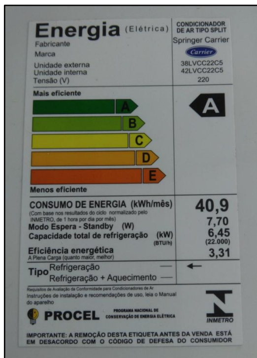
Figura 25: ENCE do condicionador de ar da Sala 902 Fonte: Arquivo pessoal, 2015
