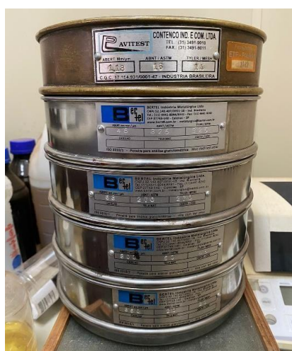
Figura 9 - Peneiras utilizadas para peneirar a amostra.
