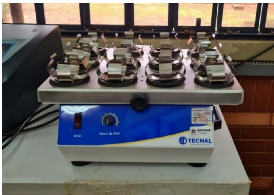
Figura 16 - Shaker TE 141 para ensaio de adsorção
