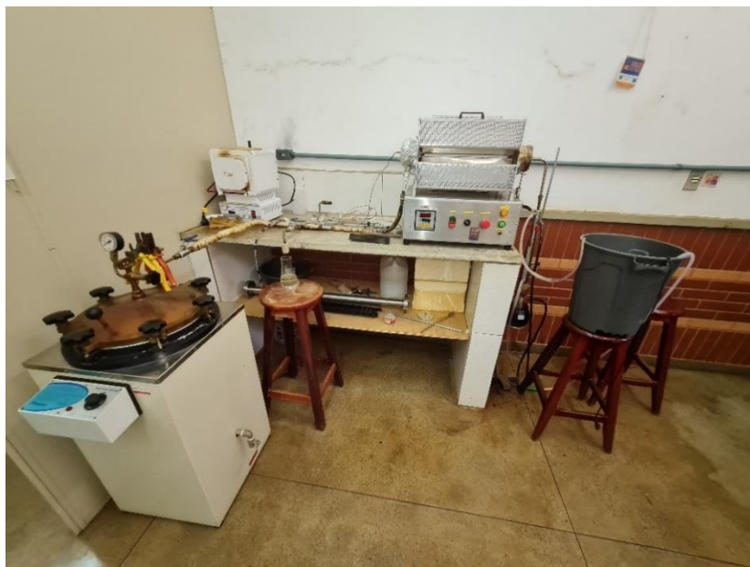
Figura 15 - Sistema completo utilizado no processo de pirólise
