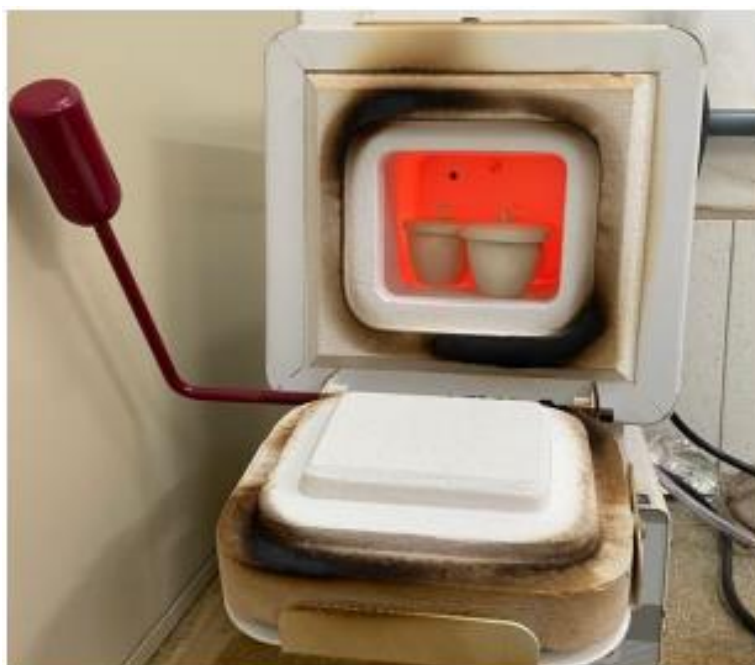
Figura 12 - Aquecimento dos cadinhos a 850°C em forno mufla
