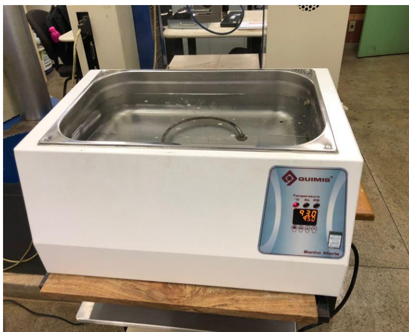
Figura 23 - Equipamento banho-maria digital
