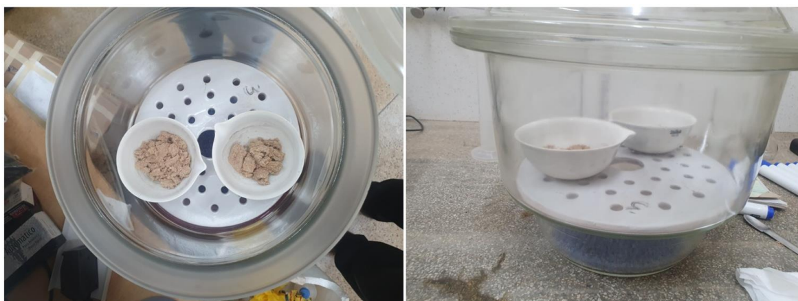
Figura 10 - Adição da biomassa ao cadinho de porcelana
