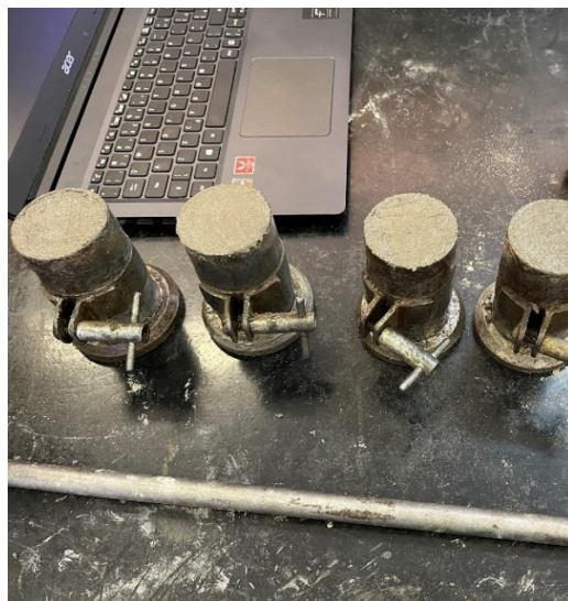
Figura 12 – Moldagem dos corpos de prova
