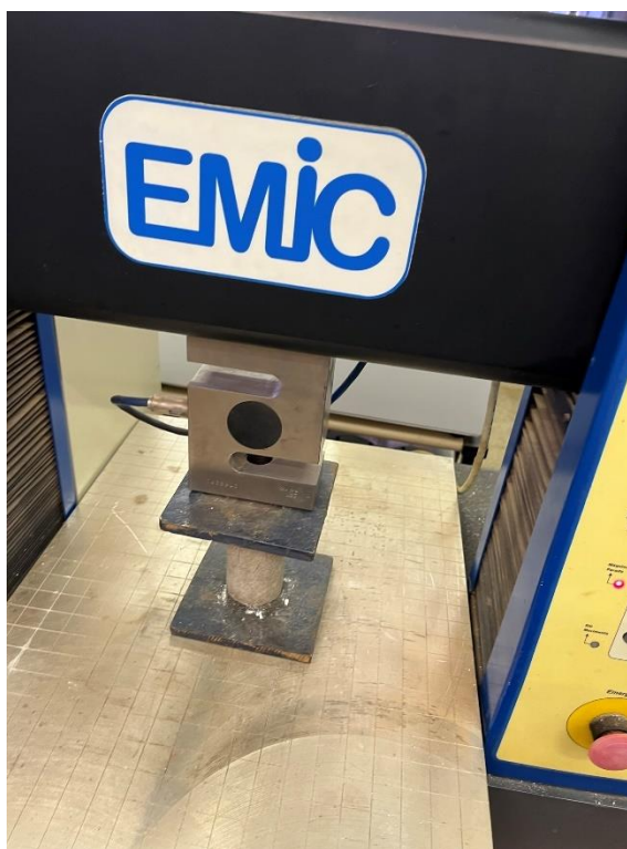
Figura 14 – Rompimento dos corpos de prova aos 7 dias.
