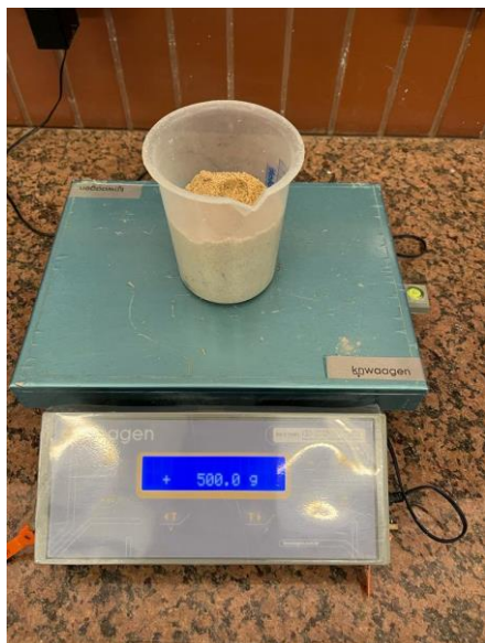
Figura 17 – Pesagem do agregado
