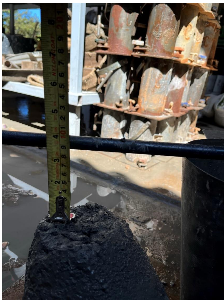
Figura 21 – Ensaio de abatimento de cone ( slump test )
