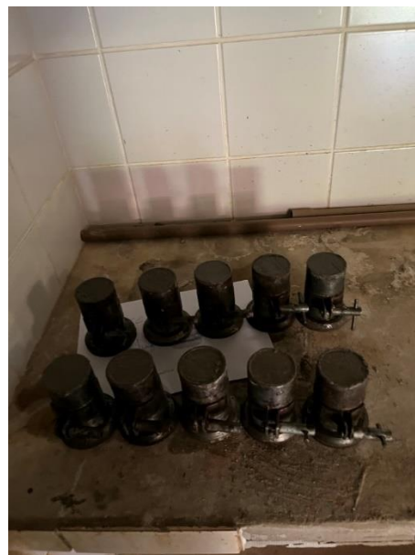
Figura 13 – Processo de cura de 7 dias.
