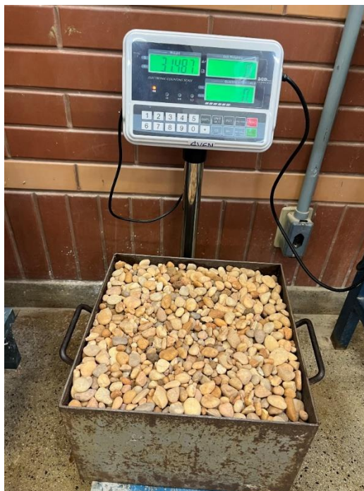
Figura 19 – Pesagem do agregado
