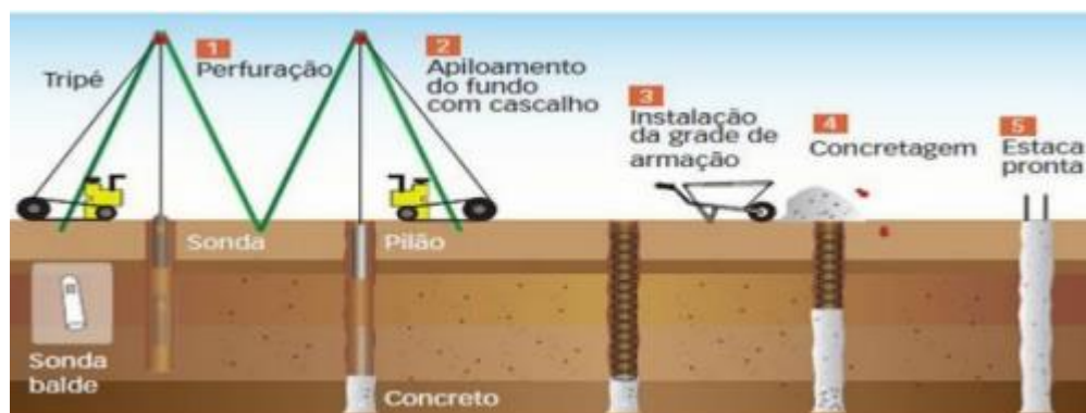
Figura 7 - Execução de Estaca Strauss
