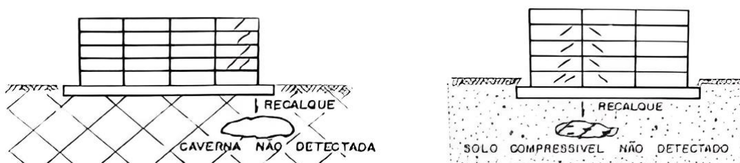
Figura 27- Deficiência na investigação geotécnica
