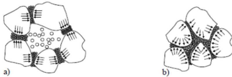
Figura 15 - Estrutura do solo colapsível carregada: a) antes da inundação; b) depois da inundação
