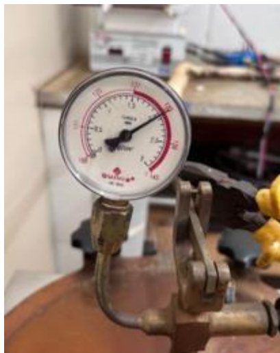
Figura 9: Temperatura ideal para o bom funcionamento do ensaio, 133°C.
