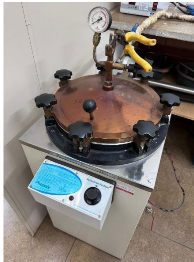
Figura 8: Autoclave, responsável pela geração do vapor d'água.
