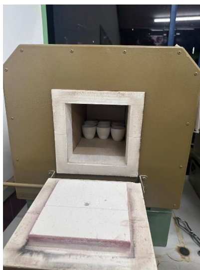
Figura 16: Cadinho com material no interior do forno mufla.
