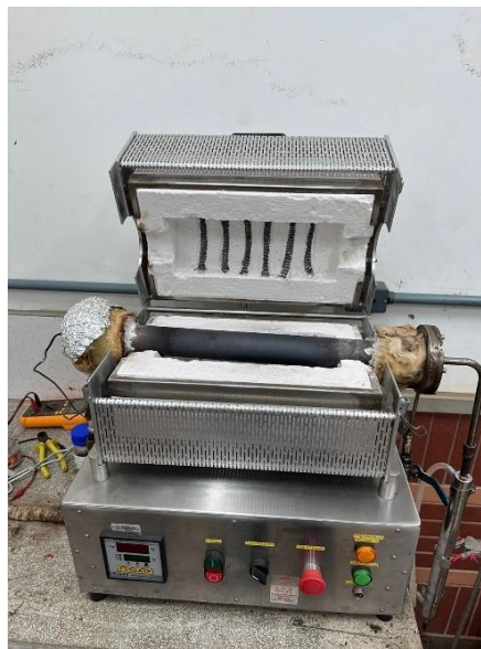
Figura 7: Reator ao qual a barca com o material foi inserida para realização da pirólise.
