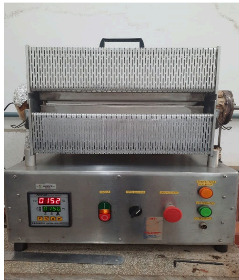
Figura 8: Reator de leito fixo que foi utilizado no ensaio de pirólise.
