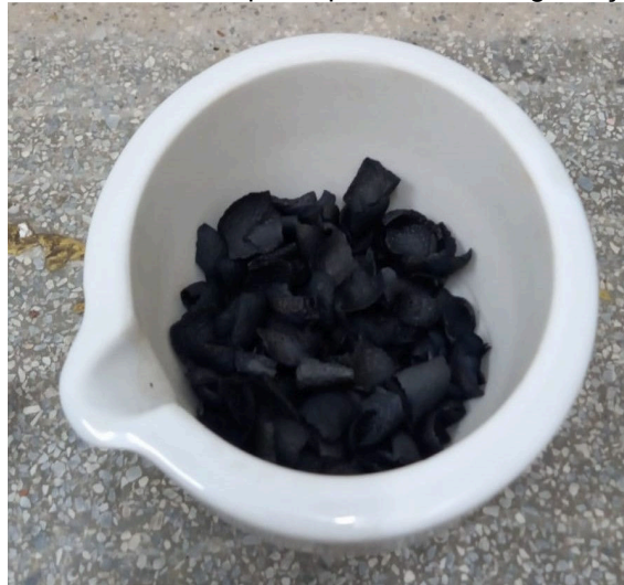
Figura 13: Carvão ativado após o processo de degradação térmica.
