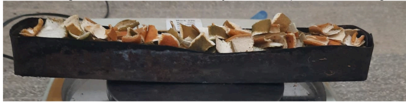
Figura 12: Barca com fragmentos de casca de laranja antes do processo de degradação térmica.
