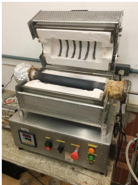
Figura 10 – Reator de leito fixo utilizado no ensaio da pirólise.
