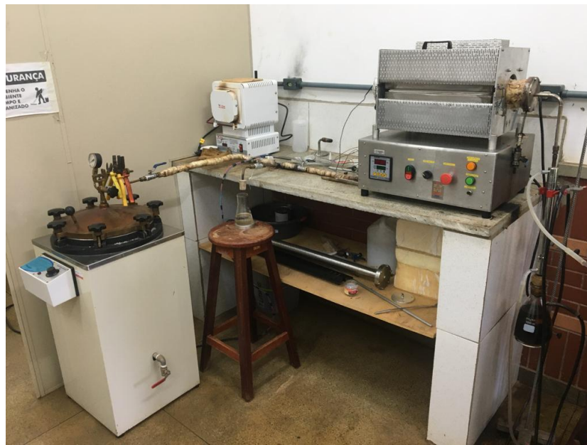
Figura 9 – Reator de leito fixo utilizado no ensaio da pirólise
