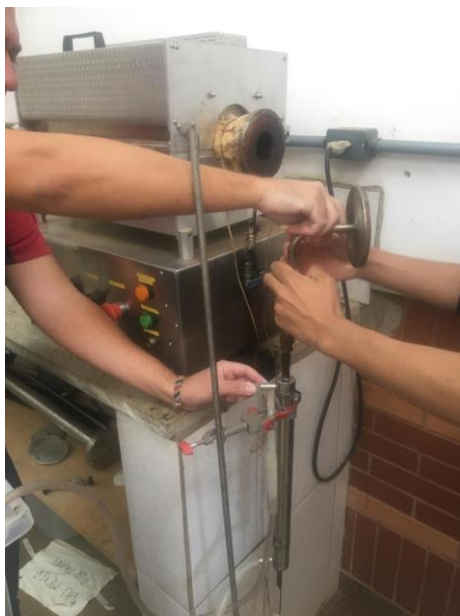
Figura 16 – Barca com amostra de lodo industrial sendo inserida dentro do reator de leito fixo.
