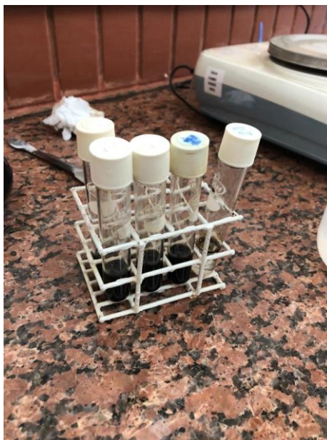
Figura 22 – Tubo de ensaio com bio-óleo originado no processo de pirólise em contato com solventes polares e apolares.
