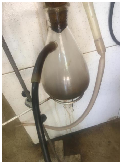
Figura 19 – Frasco separador de fases, término do processo de pirólise.
