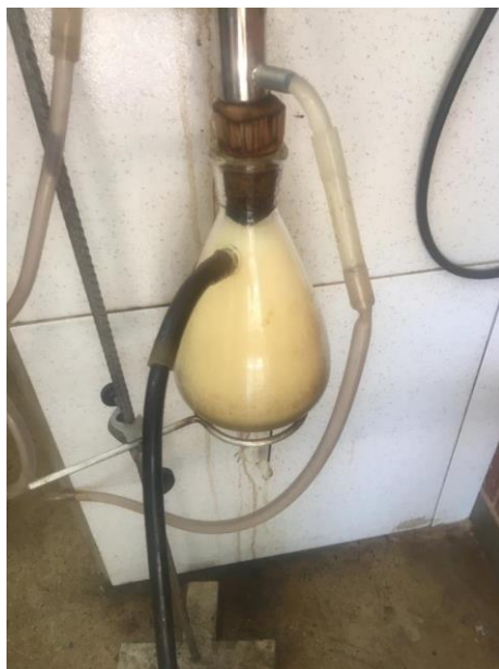
Figura 18 – Frasco separador de fases, presença de espuma amarelada característica do bio-óleo produzido.
