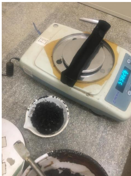
Figura 14 – Recipiente contendo o lodo industrial com o catalisador (CaO), apoiado sobre a balança está o recipiente “barca” utilizado na pirólise.
