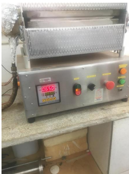
Figura 17 – Reator de leito fixo em funcionamento.
