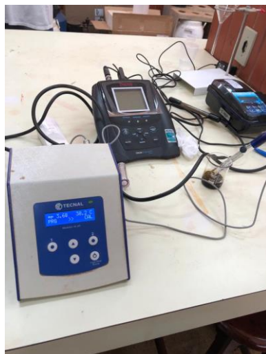
Figura 21 – pHmetro digital, análise do pH do bio-óleo produzido.
