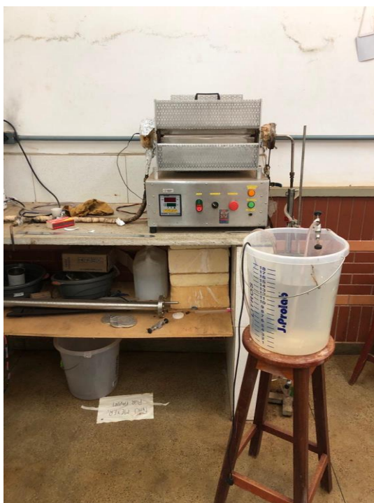
Figura 12 – Sistema empregado para o resfriamento dos vapores.
