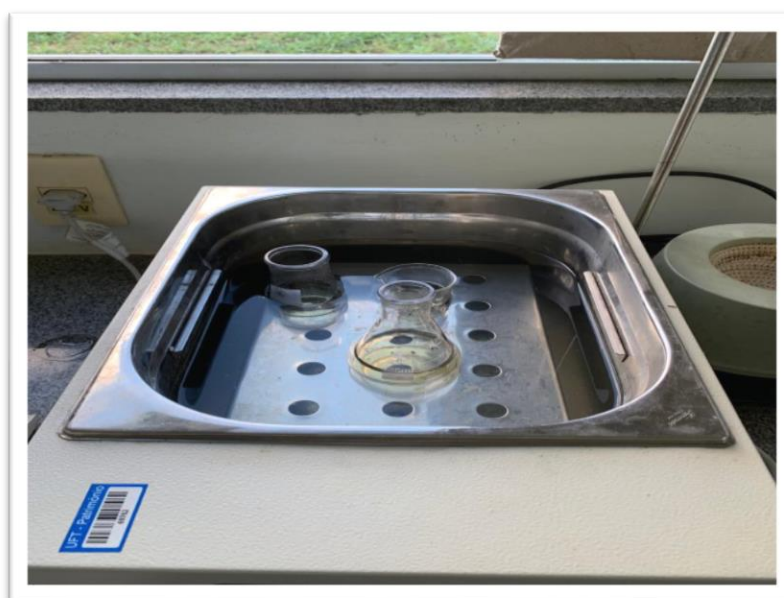
Figura 22 – Amostras Aquecendo a 75°
