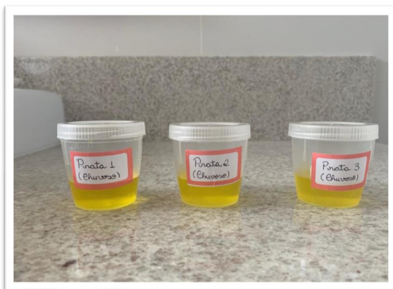
Figura 23 – Amostras de Água da Praia do Prata com o Procedimento de Oxidação de Peróxido Úmido Finalizado
