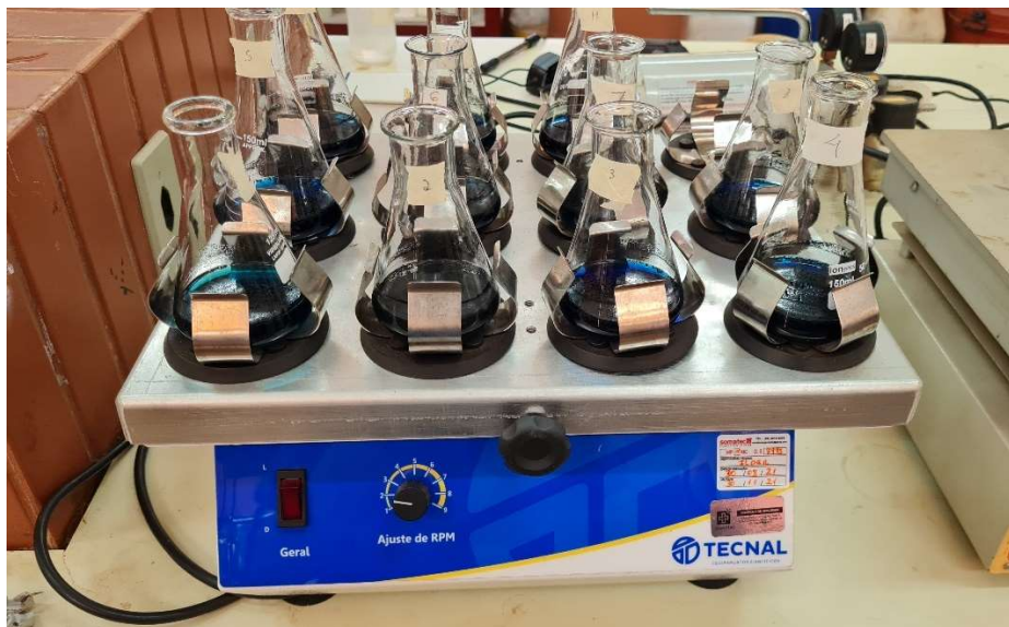
Figura 9 – Shaker TE 141 com amostras para ensaio de adsorção
