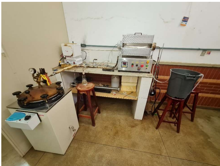
Figura 5 – Sistema com reator de leito fixo
