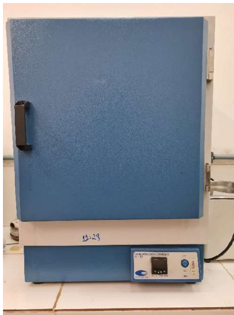
Figura 4 – Estufa utilizada para secagem da amostra
