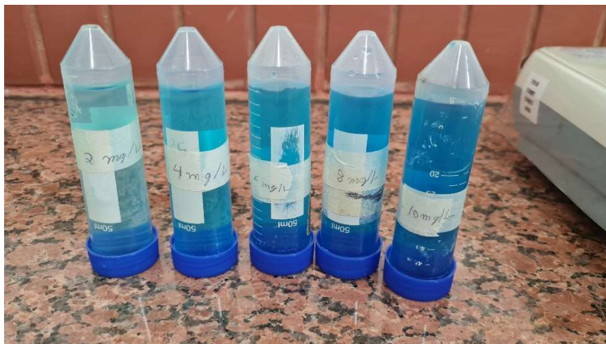
Figura 11 - Amostras das concentrações padrão para a curva calibração
