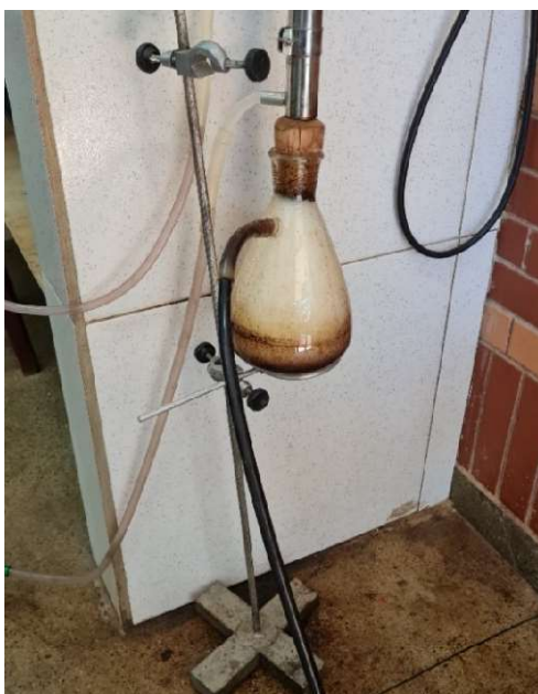
Figura 8 – Sistema de condensação da parte gasosa
