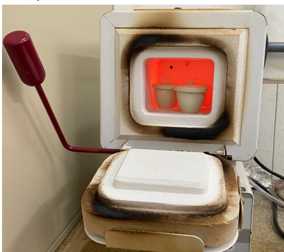
Figura 9 – Aquecimento dos cadinhos a 850°C em forno mufla.
