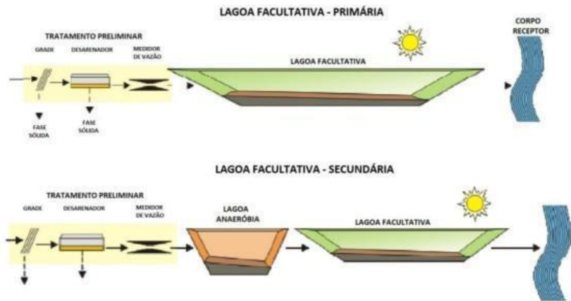
Figura 15 - Lagoas Facultativa primária e secundária, respectivamente.
