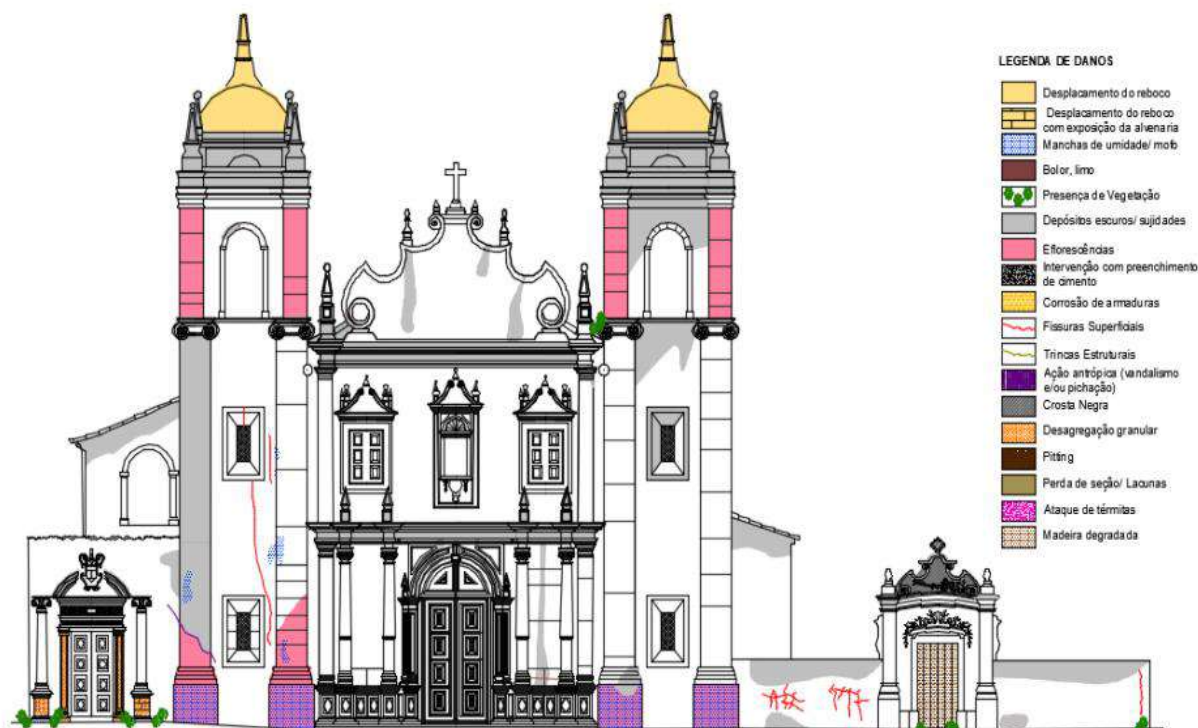
Figura 09 - Mapa de Danos da Fachada Norte da Igreja do Carmo
