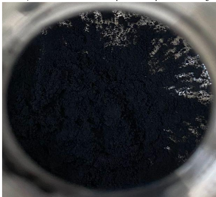
Figura 10 - Fração sólida obtida através do processo de pirólise do sabugo de milho.
