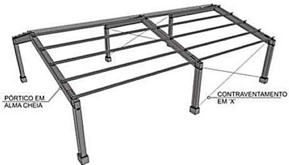
Figura 15 - Edifício industrial com colunas e vigas em alma cheia
