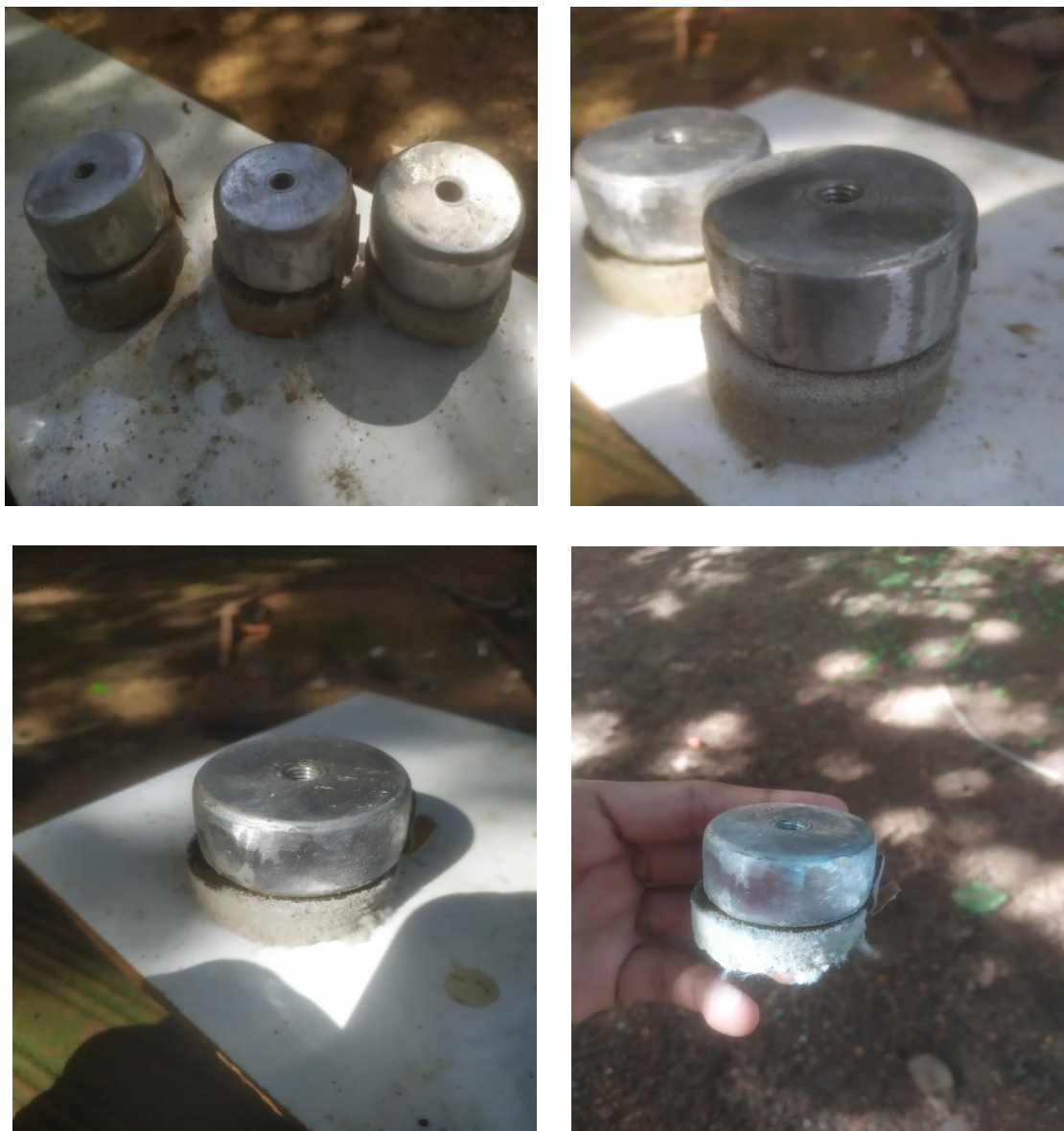
Figura 23 – Amostras das pastilhas após ensaio de arrancamento
