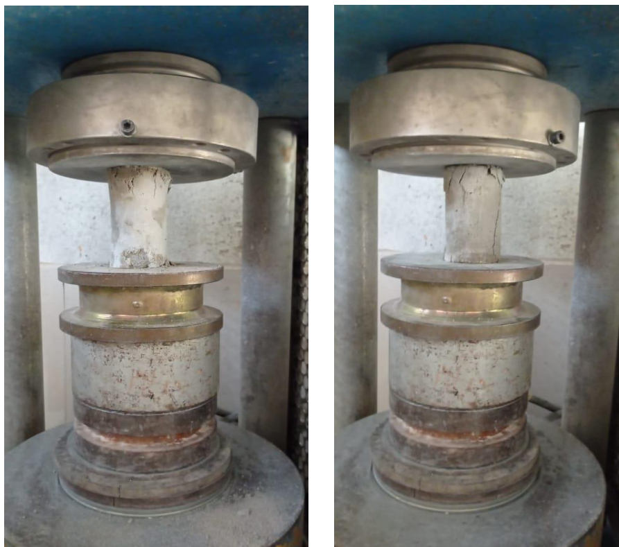
Figura 17 - Corpos de prova sendo rompidos
