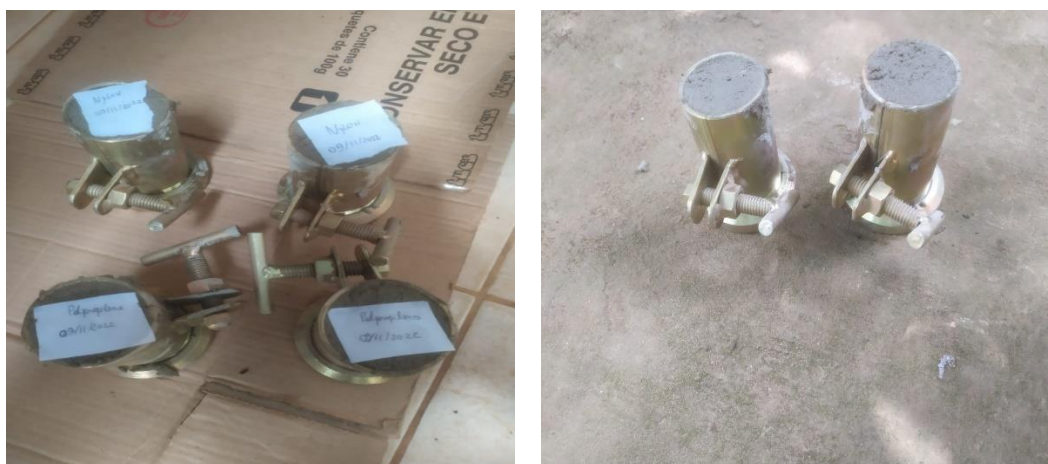
Figura 16 - Corpos de prova etiquetados para ensaio de compressão
