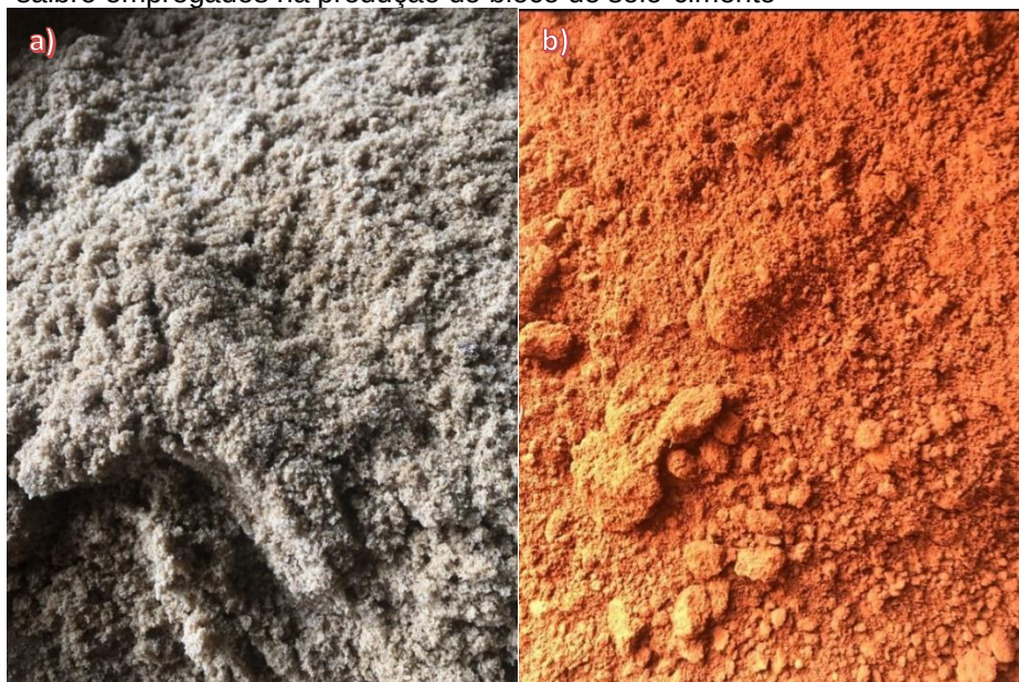
Figura 8 - (a) Fotografia agregado miúdo natural proveniente de rio; (b) Fotografia do saibro empregados na produção do bloco de solo-cimento
