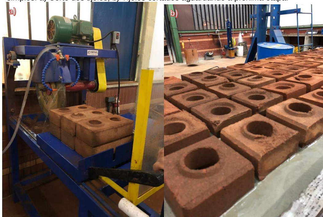
Figura 14 - Processo de preparação dos tijolos para o ensaio de resistência a compressão simples: a) Corte dos tijolos; b) Tijolos cortados aguardando a próxima etapa.
