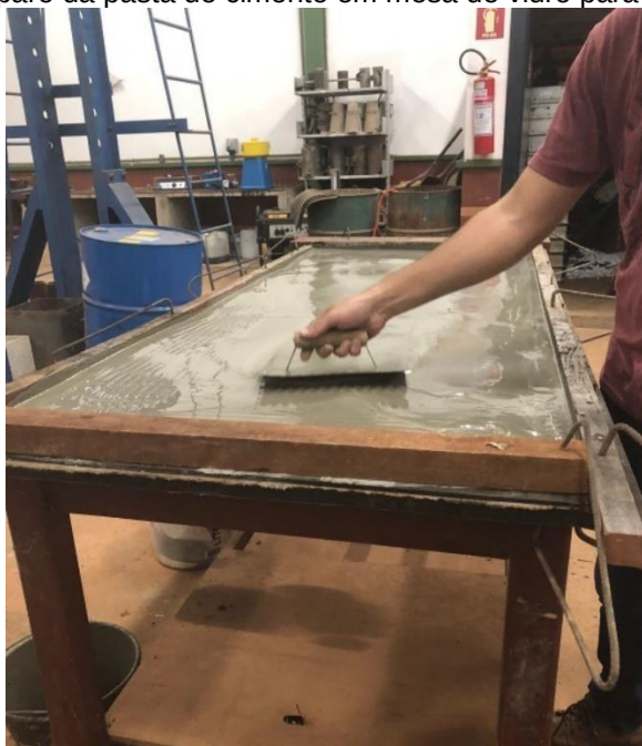
Figura 15 - Preparo da pasta de cimento em mesa de vidro para o capeamento
