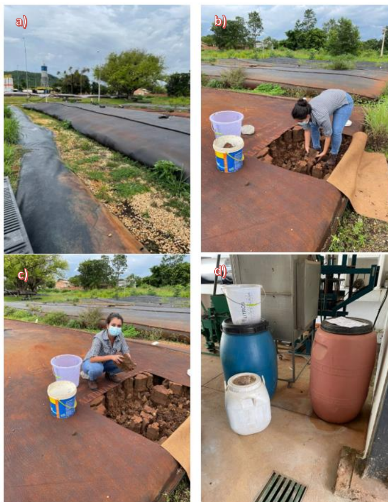
Figura 5 - Etapas do processo de coleta do lodo de ETA: a) Bags têxteis de armazenamento do lodo de ETA; b) Área onde foi realizado o rasgo para coleta; c) coleta do Lodo de ETA; d) Lodo de ETA já coletado e armazenado no laboratório do IFTO
