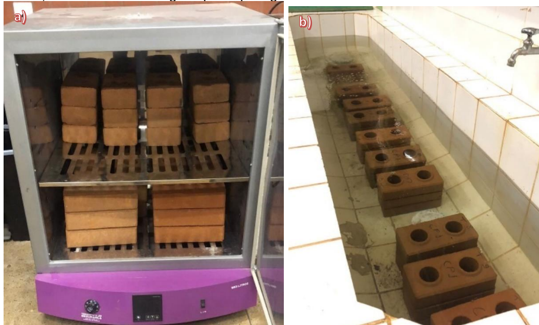
Figura 18 - Processo de preparação para o teste de absorção de água: a) Blocos em estufa a 100°C; Bloco imersos em água após a pesagem seca
