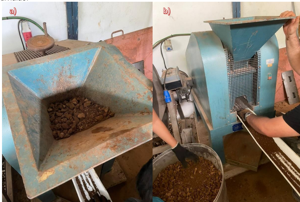
Figura 6 - Representação das etapas de processamento do Lodo da ETA: a) Diâmetro do Lodo de ETA b) Lodo de ETA passando pelo britador no processo de obtenção do material finamente dividido.
