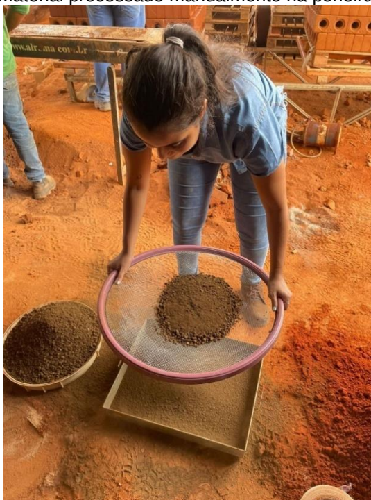
Figura 7 - Material processado manualmente na peneira circular
