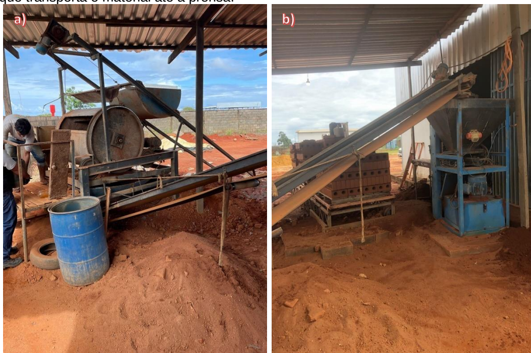
Figura 6 - Processo de mistura e homogeneização dos traços: a) Multiprocessador; b) Esteira que transporta o material até a prensa.
