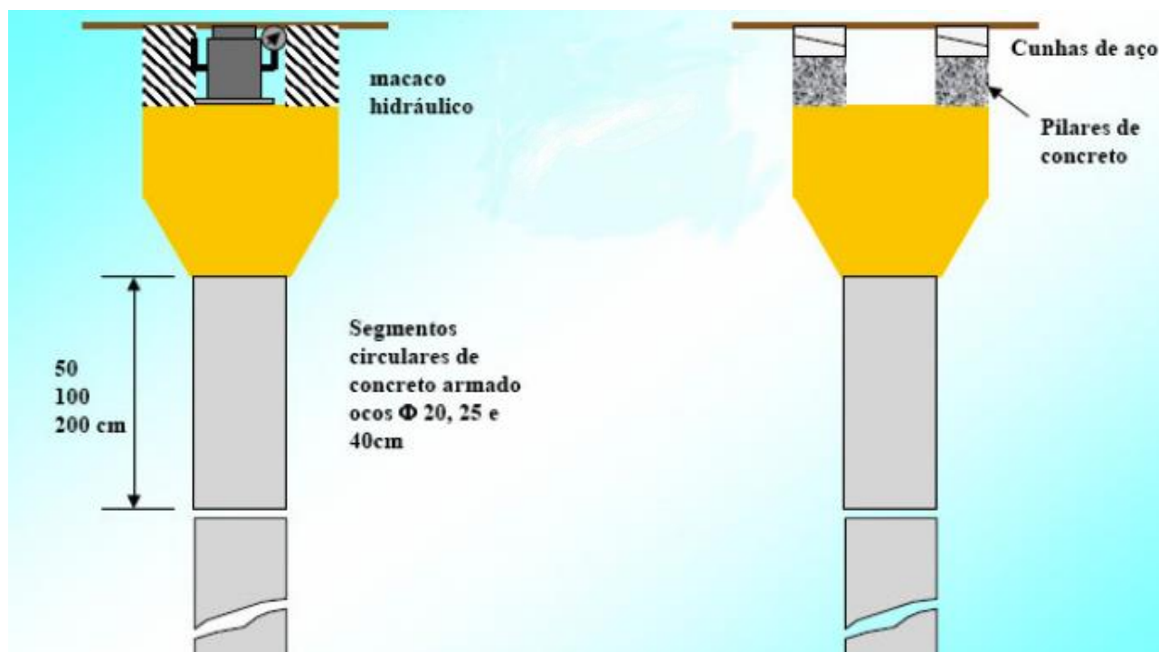
Figura 75 – Esquematisação da execução de Estacas Mega
