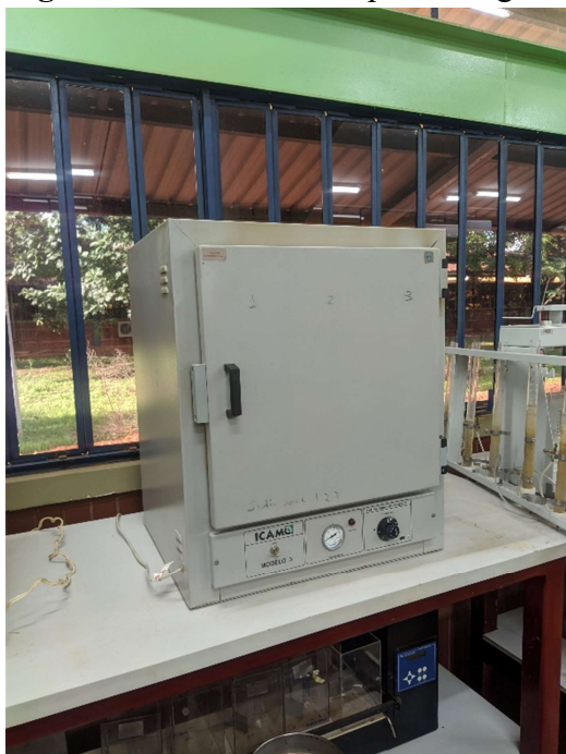
Figura 20 – Forno mufla para secagem (1)
