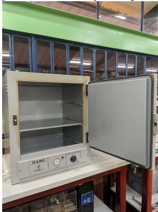
Figura 21 – Forno mufla para secagem (2)
