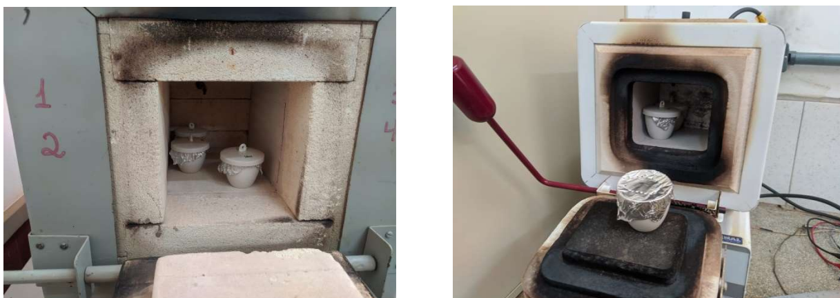
Figura 22 – Forno mufla para determinação do material volátil
