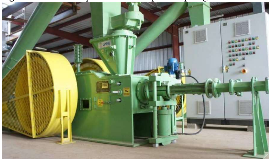
Figura 9 – Prensa de pistão mecânico para briquetagem
