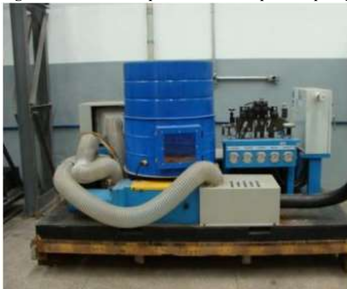
Figura 10 – Prensa de pistão hidráulico para briquetagem
