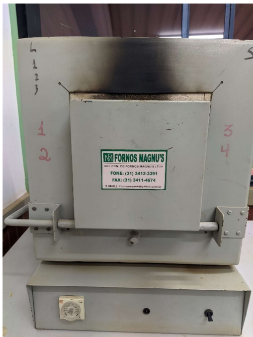
Figura 23 – Forno mufla para pirólise (1)
