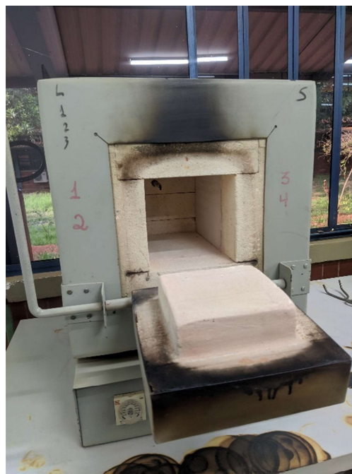
Figura 24 – Forno mufla para pirólise (2)
