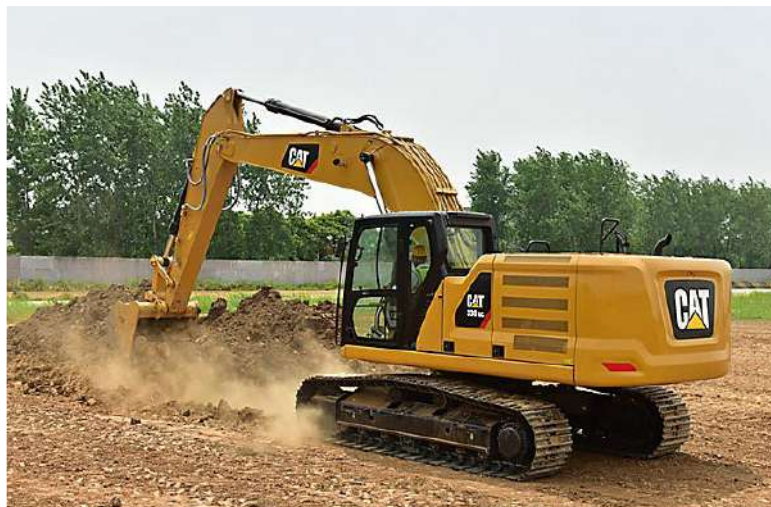
Figura 20– Escavadeira hidráulica sobre esteiras
