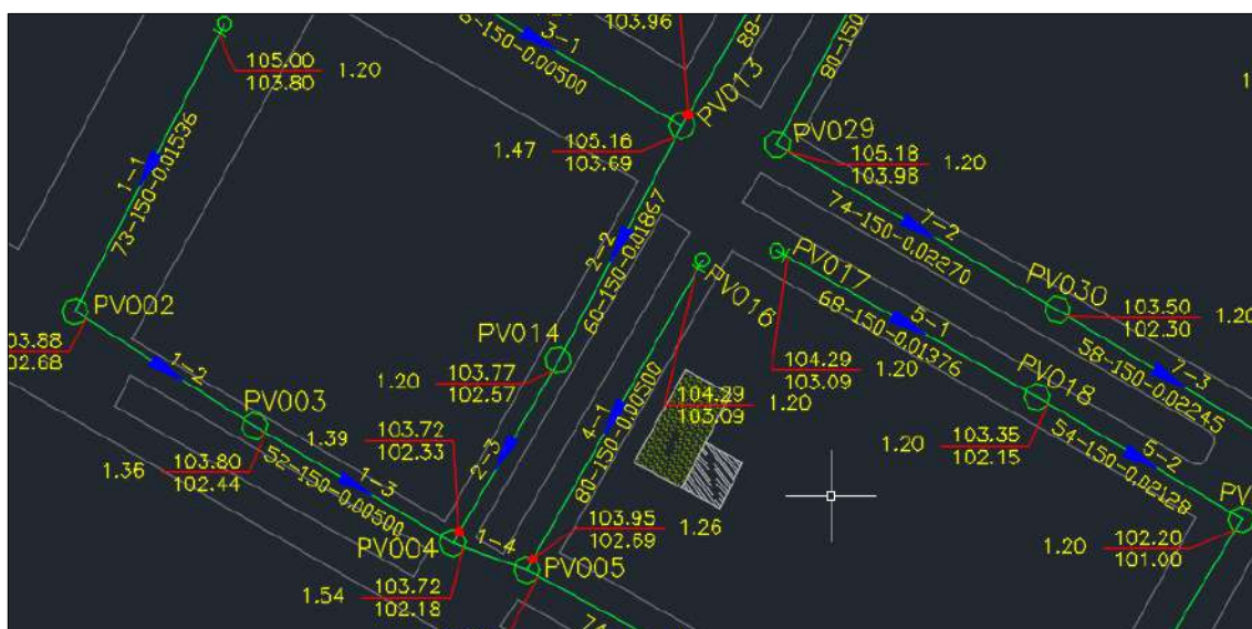
Figura 40- Projeção da rede coletora na sub-bacia 2
