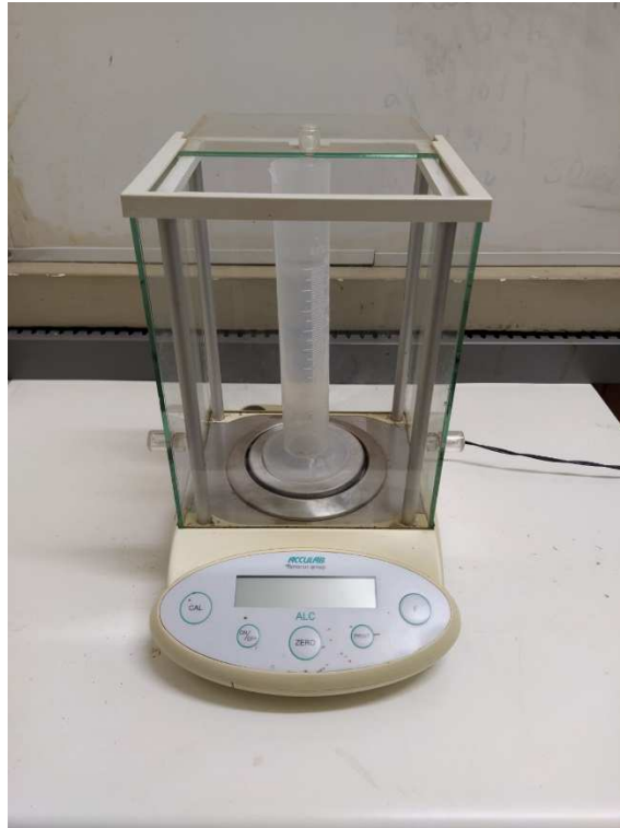
Figura 8 - Balança analítica para determinação da massa específica do óleo Fonte: Autor (2020)
