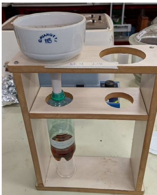
Figura 22 - Sistema de filtração do óleo adsorvido
