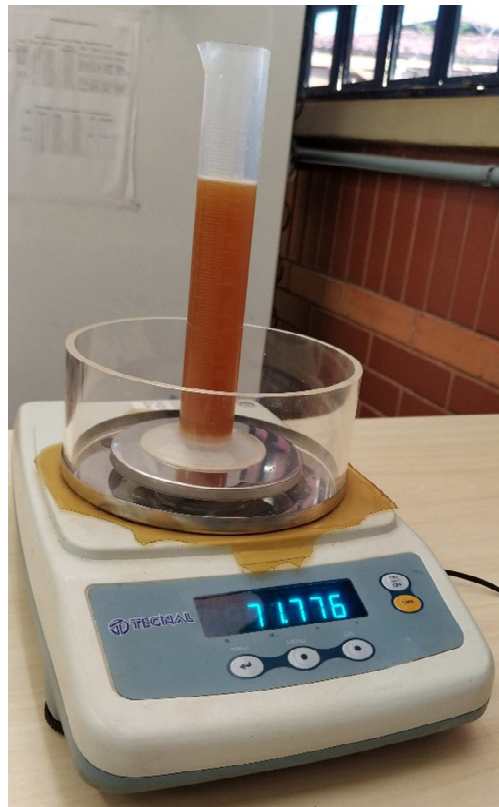
Figura 9 - Determinação da massa do óleo residual Fonte: Autor (2020)
