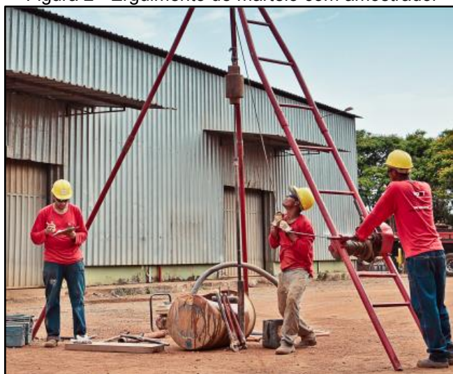
Figura 2 - Erguimento de martelo com amostrador
