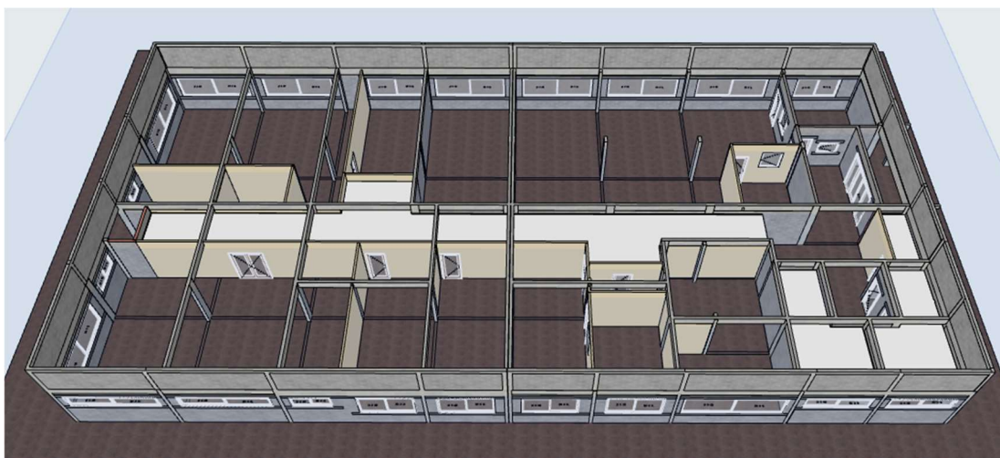
Figura 23 – Ambientes com acabamento do tipo 2 – Forro termoacústico
