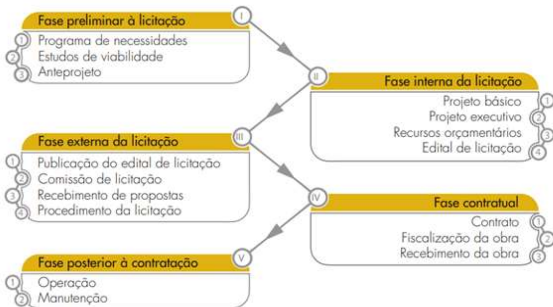
Figura 2 - Fluxograma das fases de uma obra pública com execução indireta.
