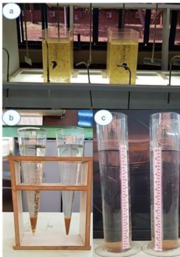
(a) Adição de Polímeros no LETA; (b) Medição de turbidez – Solução I; (c) Ensaio de Adensamento por Gravidade – Solução II.
