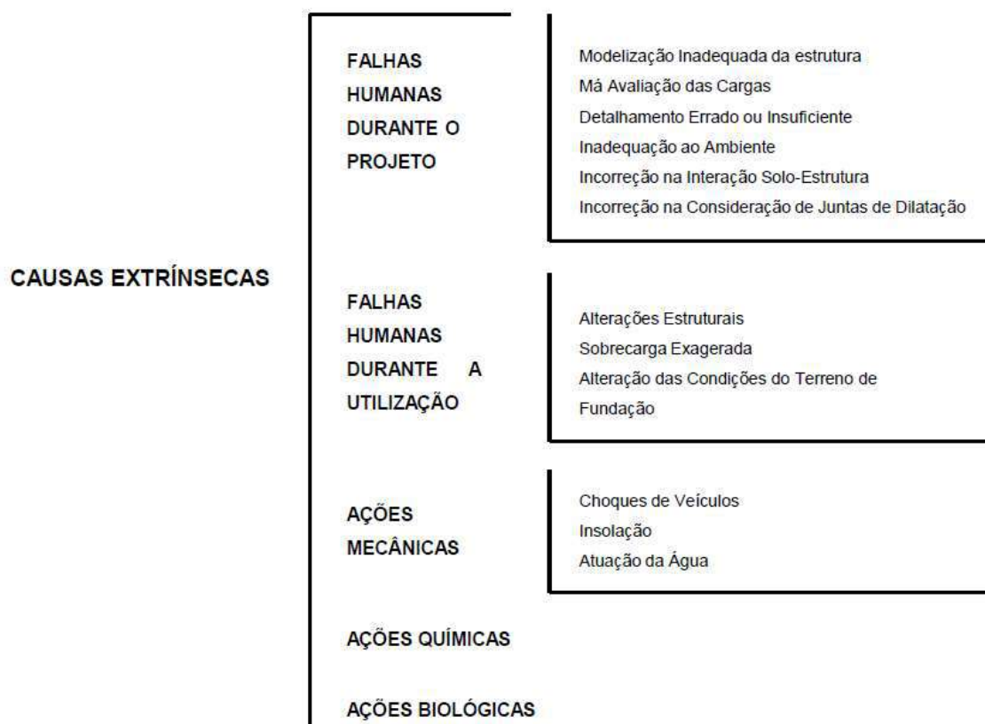
Figura 11: Causas extrínsecas das patologias em concreto armado
