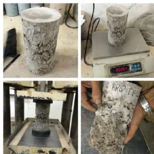
Figura 26 – Ninhos de concretagem em corpo de prova
