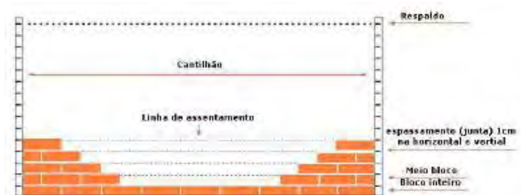
Figura 23-Imagem ilustrativa da execução da parede de alvenaria
