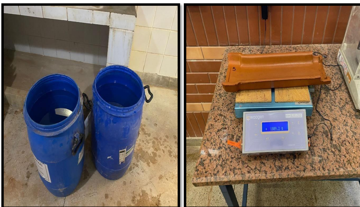
Figura 12 – Ensaio de absorção de água em telhas cerâmicas comercializadas em Palmas – TO.
