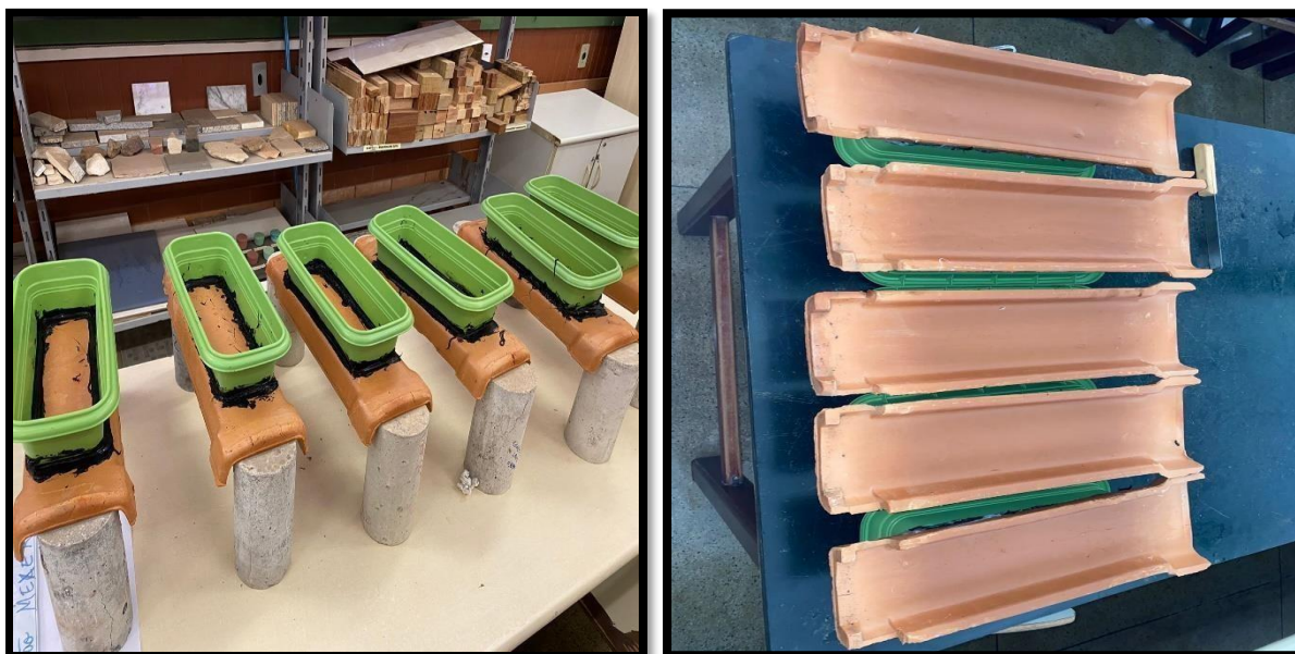
Figura 14 – Ensaio de impermeabilidade em telhas cerâmicas comercializadas na cidade de Palmas – TO.
