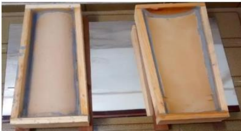
Figura 6- Telhas montadas para a realização do ensaio de impermeabilidade.
