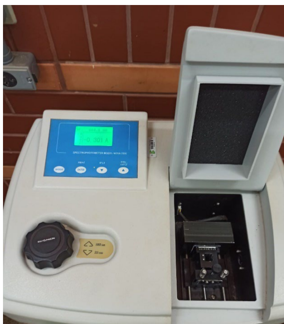
Figura 14 - Leitura das absorbâncias espectrofotômetro, a 660 nm.
