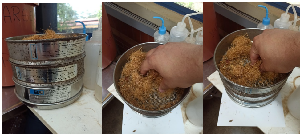
Figura 6 - Processo de peneiração da biomassa do coco verde, em malha MESH-10 de 2,00 mm, com agitação manual.
