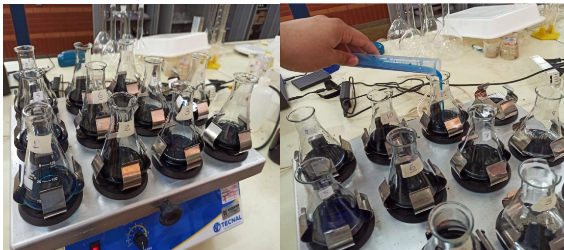
Figura 12 - Agitação das soluções de azul de metileno com os carvões.
