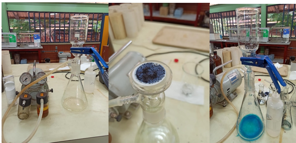
Figura 13 - Procedimento de filtragem do azul de metileno em papel analítico.
