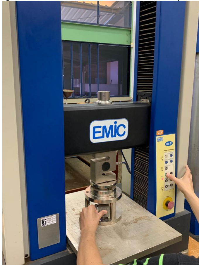
Figura 19 - Ensaio de resistência mecânica de compressão
