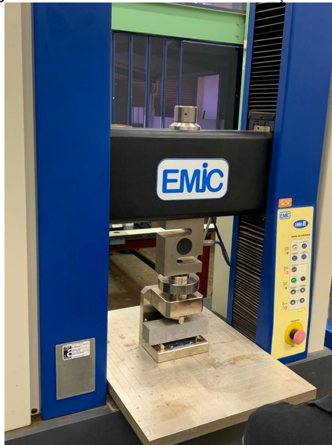
Figura 18 - Ensaio de resistência mecânica de tração na flexão
