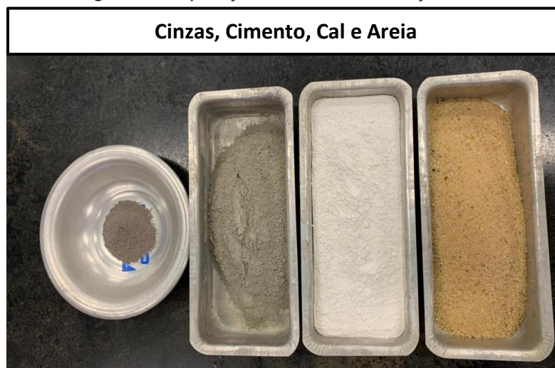
Figura 4 - Separação dos materiais: Traço de 4%
