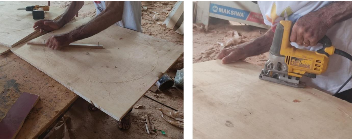
Figura 38 - Marcação e corte do compensado com serra tico-tico
