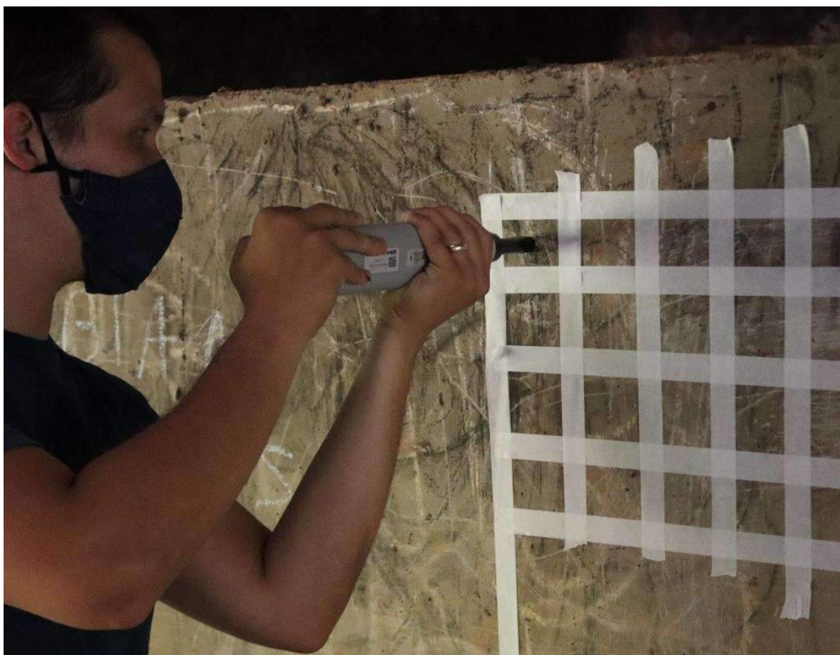
Figura 88 – Ensaio de esclerometria em viga de travamento dos pilares leste, sentido leste-oeste
