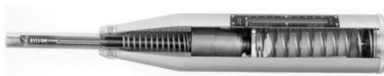
Figura 23 – Martelo de Schmidt (corte longitudinal)
