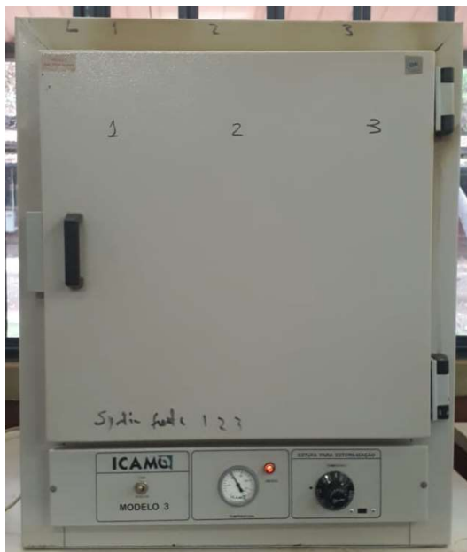
Figura 7- Modelo de estufa utilizado no ensaio de teor de umidade.
