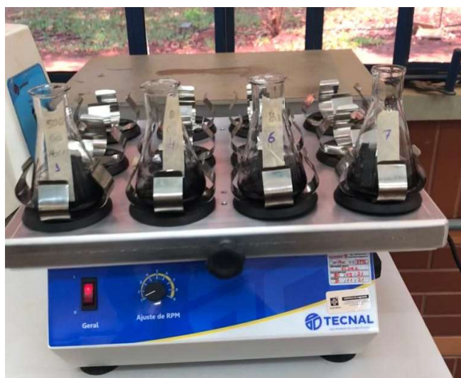
Figura 12- Mesa agitadora orbital Shaker TE 141 (TECNAL).
