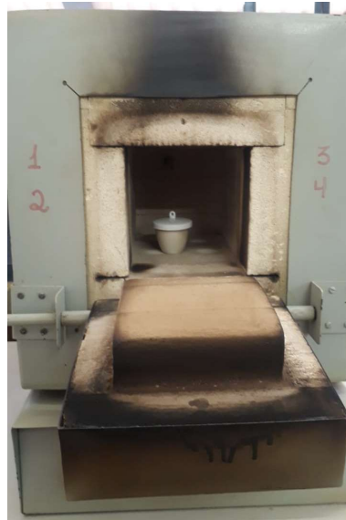
Figura 9- Forno de mufla utilizado no ensaio de materiais voláteis.
