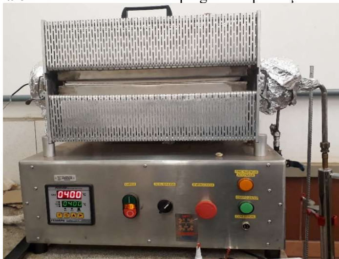
Figura 6- Reator de leito fixo empregado na produção do carvão.
