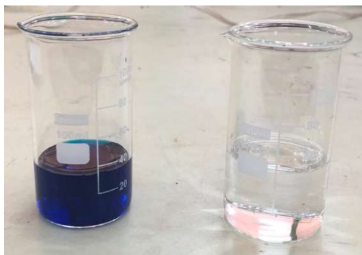
Figura 18- Solução com concentração de 100 mg/L antes e após filtragem.
