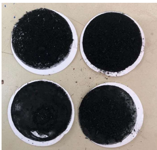
Figura 15- Papéis-filtro qualitativos após a filtração da amostra.
