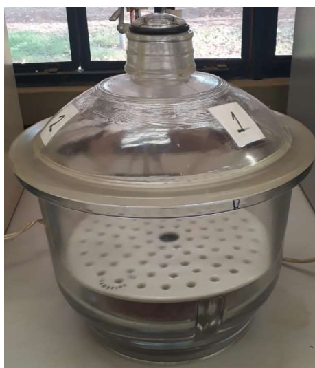
Figura 8- Dessecador empregado no ensaio de teor de umidade.
