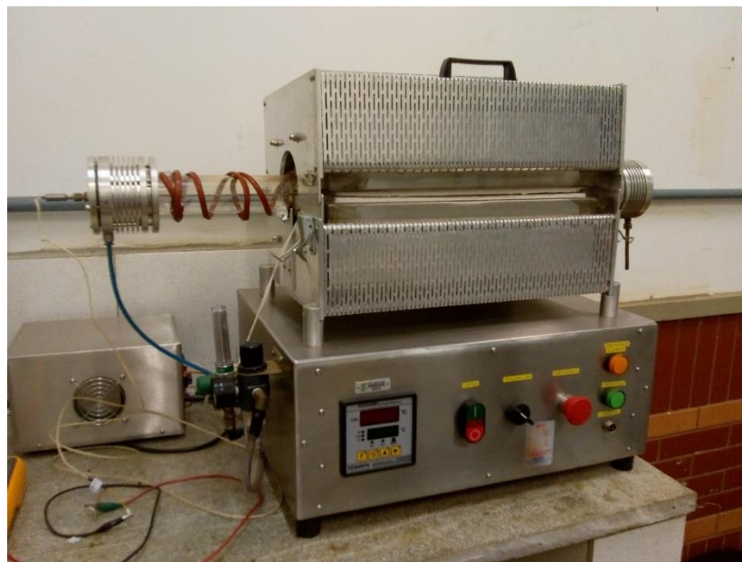
Figura 9 - Reator de leito fixo empregado nos experimentos de pirólise de biomassa
