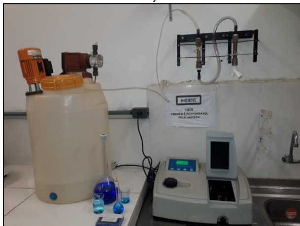
Figura 13 - Sistema de descloração de água de abastecimento obtido da pirólise de bagaço de cana-de-açúcar
