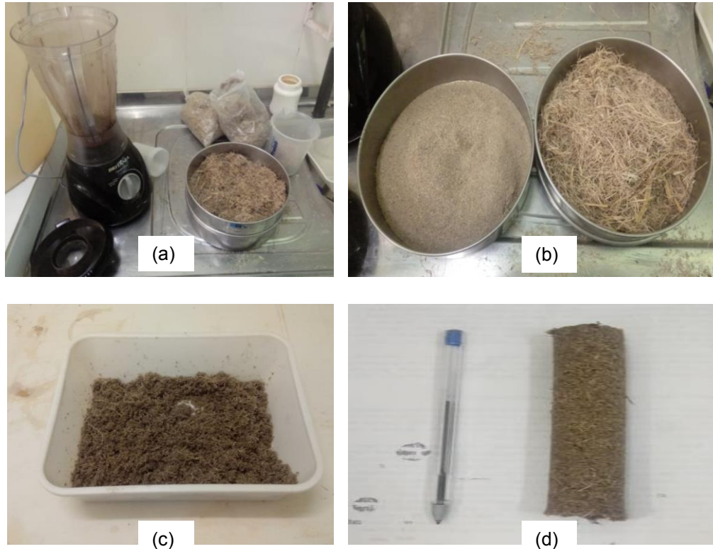
Figura 7 - Preparação da amostra (a) Processamento do bagaço de cana (b) bagaço in natura e após o processamento (c) Biomassa com adição de água (d) Briquete produzido
