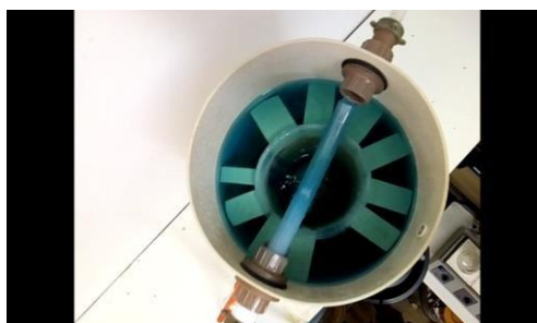
Figura 15: Sistema de filtração de corante em carvão obtido da pirólise da fibra de coco – Reservatório superior.
