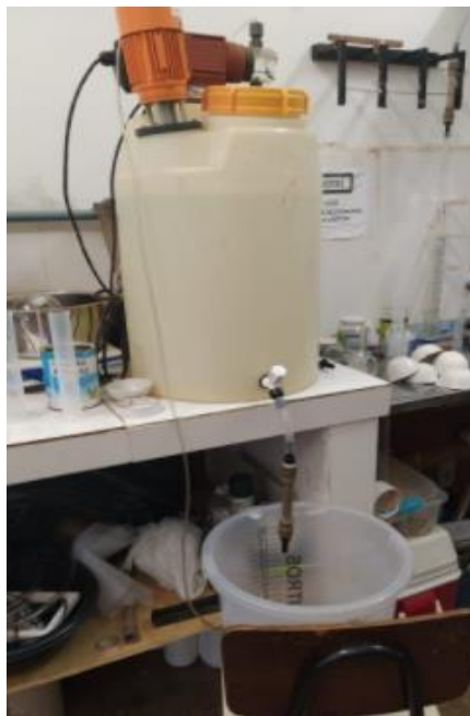
Figura 18- Sistema de descoloração de água de abastecimento.
