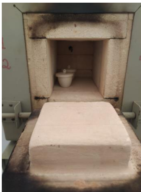
Figura 13- Mufla aquecida com cadinhos no seu interior
