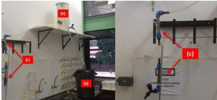
Figura 14- Sistema de filtração de corante em carvão obtido da pirólise da fibra de coco.
