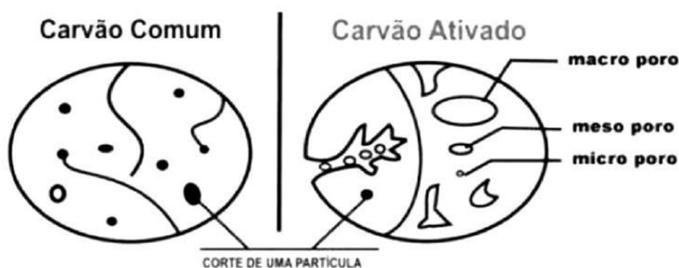
Figura 9- Esquema da estrutura dos poros do carvão ativado.
