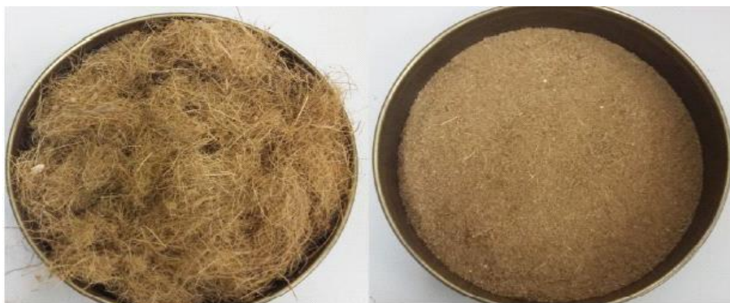
Figura 11- Amostras de fibra de coco inteira e trituradas em moinho de facas.
