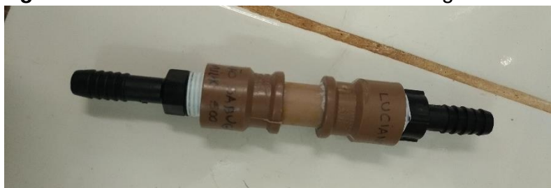
Figura 16 – Filtro de carvão ativado de sabugo de milho
