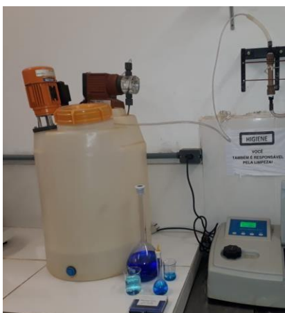
Figura 15 - Sistema de decoloração de água de abastecimento.
