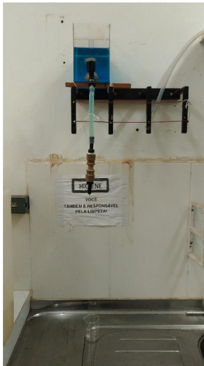
Figura 13- Sistema de filtração de corante em filtro descendente
