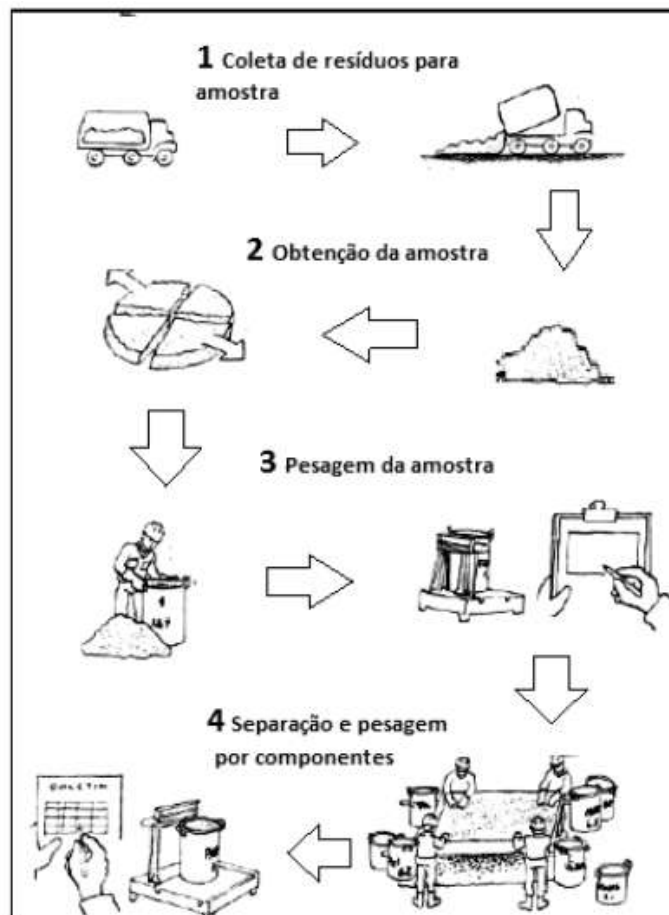
Figura 13 - Procedimento de coleta e análise de amostra para realização da técnica de quarteamento.
